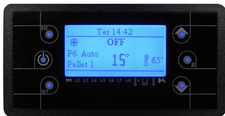
Funcionalidades: Acendimento automático, função cronotermostato com possibilidade de programação, diária, semanal e de fim-de-semana, arranque automático à hora programada e regulação automática da temperatura desejada, modulação automática (potência 1 a 6 e auto), ajusta a potência do queimador às necessidades de aquecimento e de acordo com a temperatura da água desejada, visualização de todos os parâmetros da caldeira, possibilidade de conexão com o termostato de ambiente externo.
